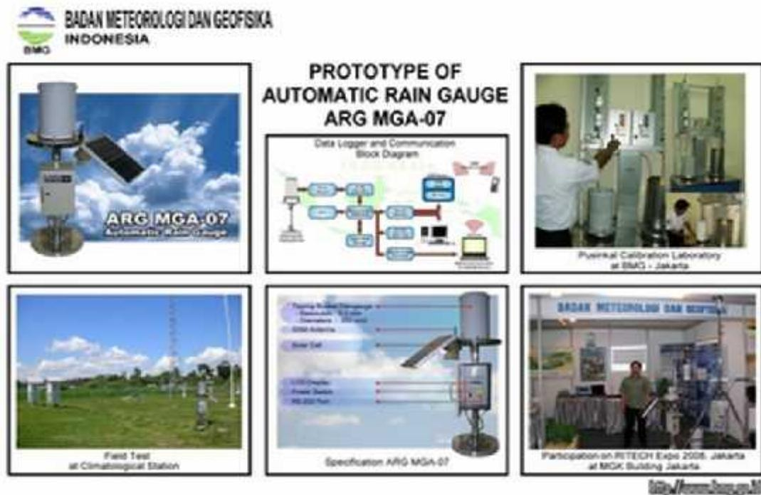
Komponen ARG ada dua yaitu Badan ARG yang berfungsi untuk menampung dan mengukur curah hujan, serta Logger ARG yang berfungsi untuk menghitung dan mencatat data curah hujan (lihat gambar 1).
